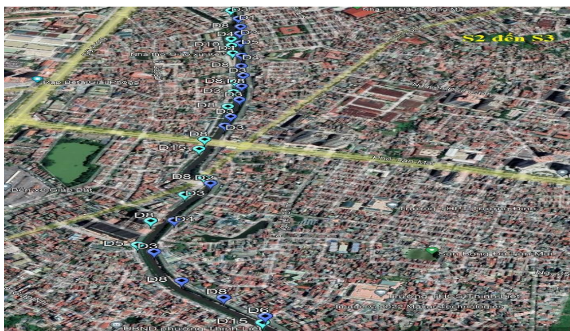
Hình 2. Vị trí và đường kính cống xả từ S2 đến S3 của sông Sét
