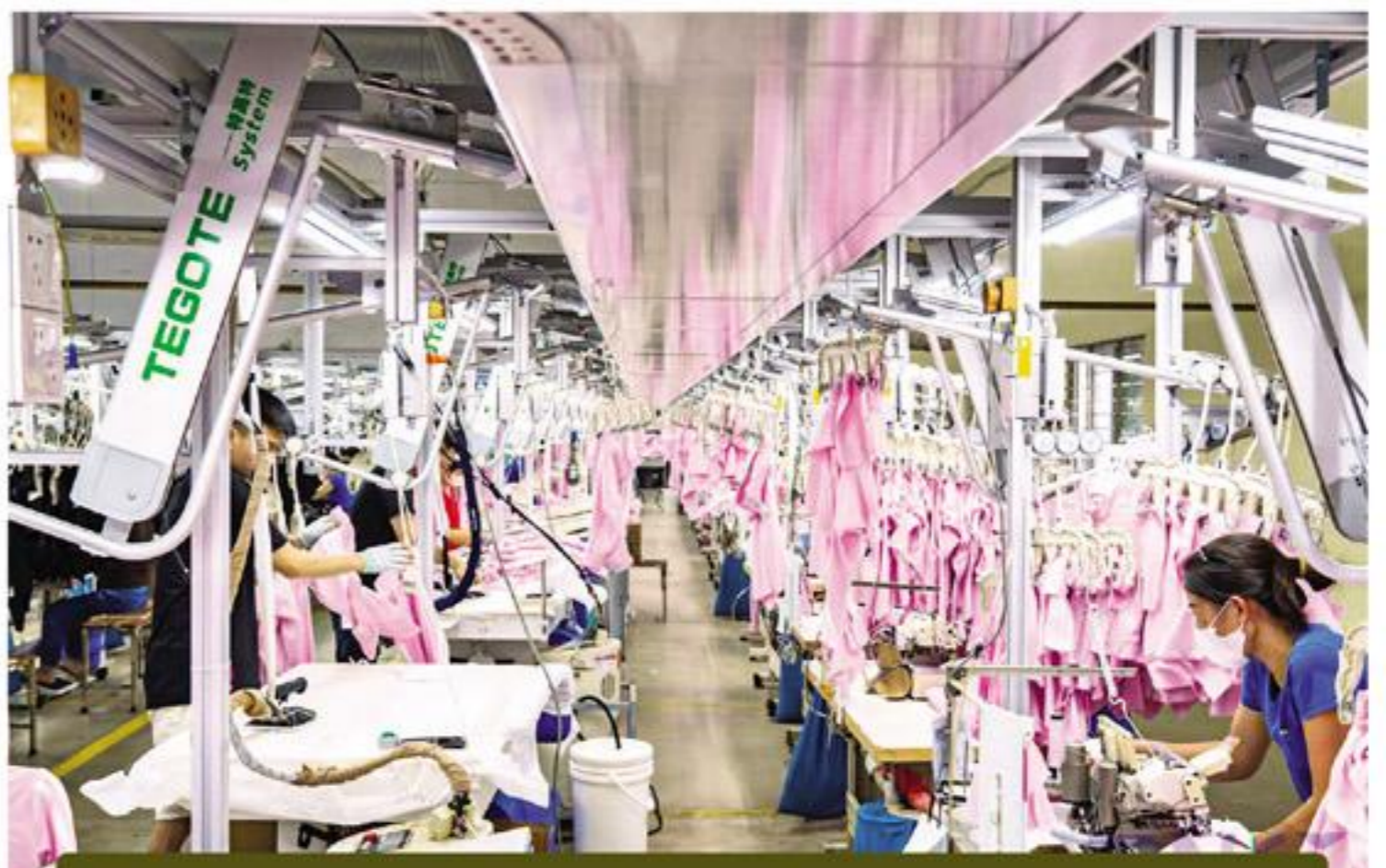
Thái Nguyên đang thúc đẩy ứng dụng khoa học, công nghệ, đổi mới sáng tạo và chuyển đổi số trong tất cả các lĩnh vực (Trong ảnh: Công ty cổ phần Đầu tư và Thương mại TNG triển khai thành công hệ thống chuyển treo tự động tại Nhà máy Đại Từ).
