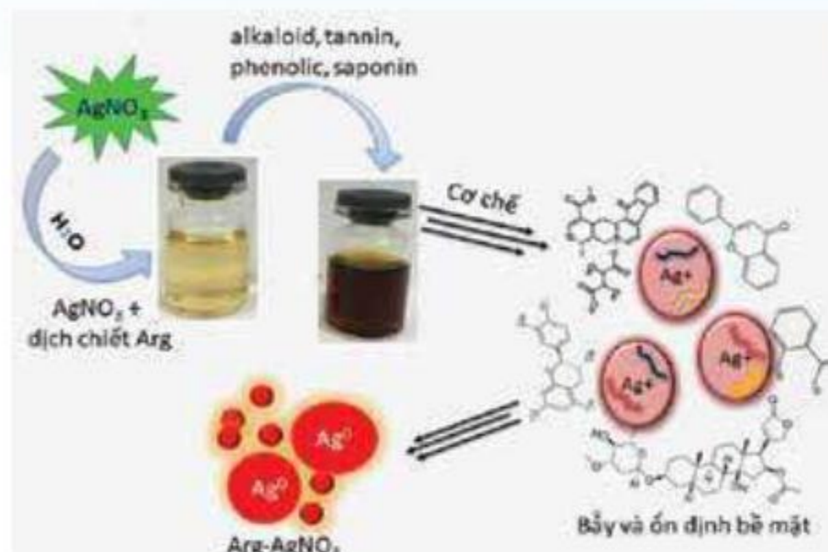
Hình 3. Tổng hợp hạt nano bạc (AgNP) bằng dịch chiết lá Khôi (Arg) với dung dịch bạc nitrat ( AgNO_3 )
