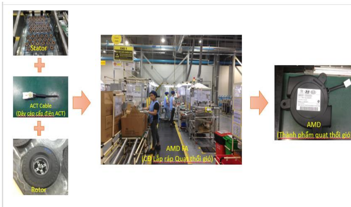
Hình 7. Hình ảnh quy trình công nghệ sản xuất thiết bị thổi khí
