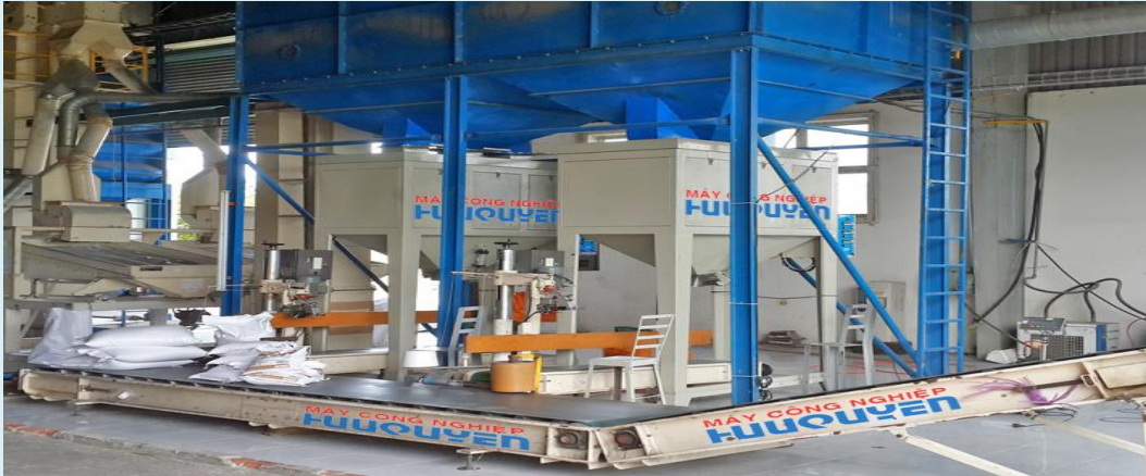
Cân đóng bao tự động 45 tấn /giờ tăng năng suất, giảm chi phí nhân công và thời gian lao động.
