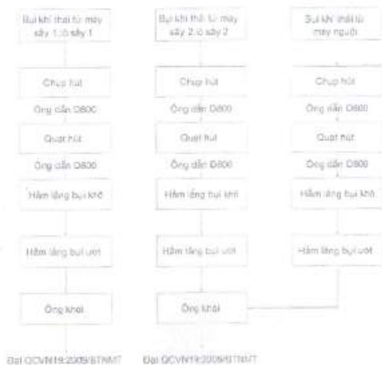
Quy trình vận hành của hệ thống xử lý bụi, khí thải
