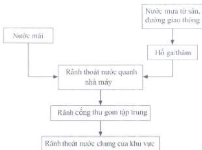
Hình 3.1. Sơ đồ thu gom, thoát nước mưa
