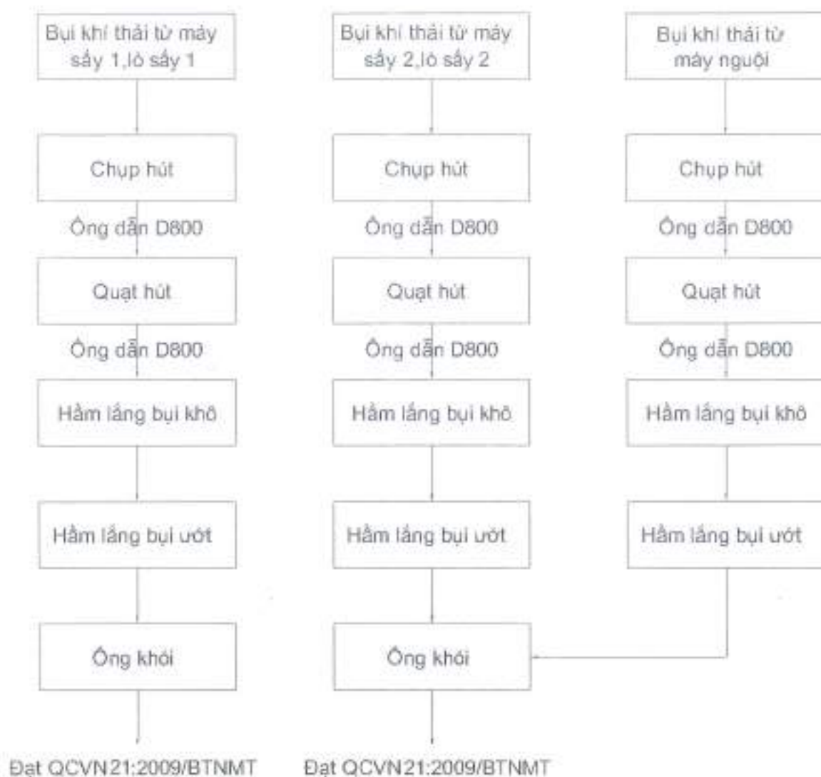
Hình 3.8. Quy trình vận hành của hệ thống xử lý bụi, khí thải xử lý bụi dây chuyền sản xuất phân bón vô cơ
