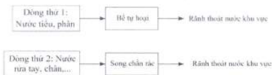
Hình 3.2. Sơ đồ thu gom, thoát nước thải
