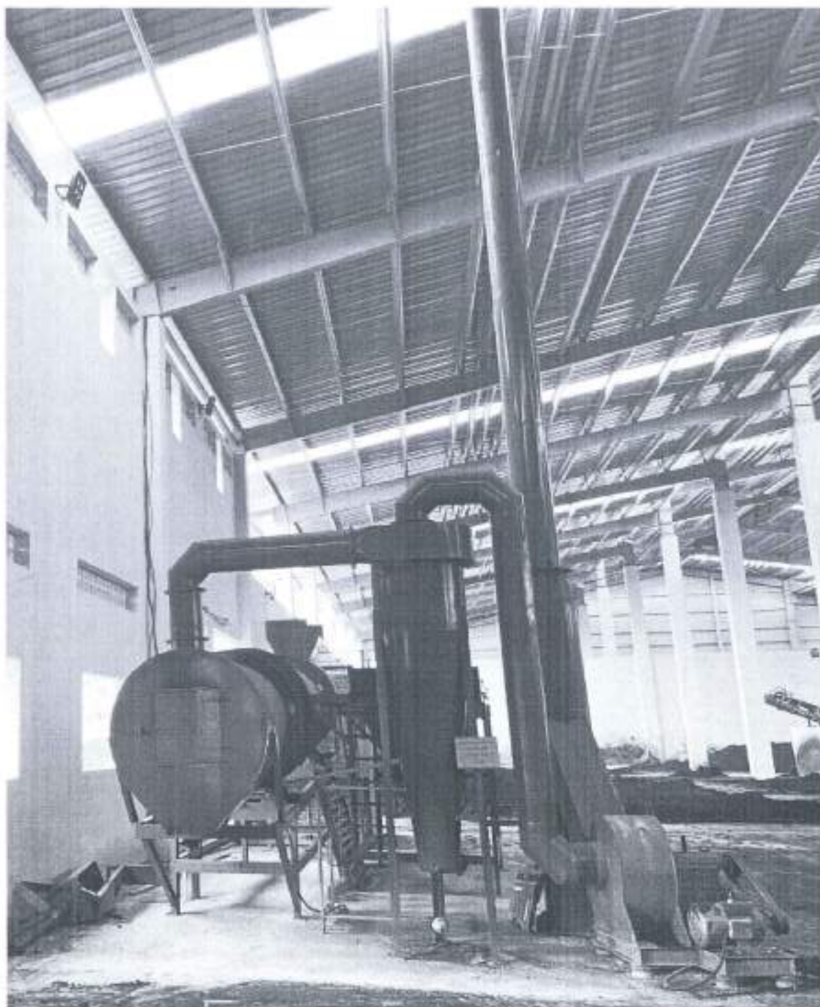
Hình 3.11. Hình ảnh hệ thống xử lý khí thải dây chuyền sản xuất phân bón hữu cơ
