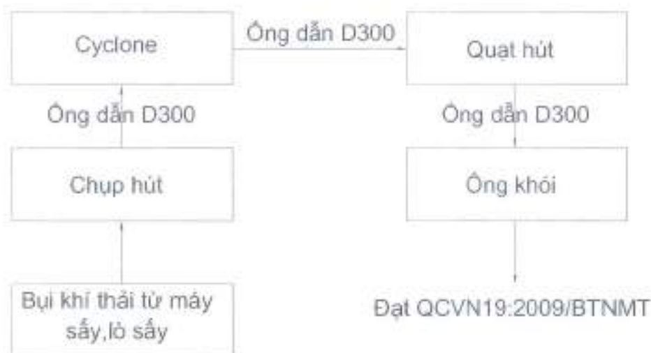
Hình 3.12. Quy trình vận hành của hệ thống xử lý bụi, khí thải xử lý bụi dây chuyền sản xuất phân bón hữu cơ
